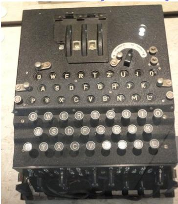
La machine Enigma est un dispositif de chiffrement transportable, électromécanique qui a été utilisé par les Allemands lors de la seconde guerre mondiale. Elle permettait de chiffrer et de déchiffrer les messages afin de protéger leur confidentialité. L'idée de cet exercice est de calculer le nombre total d'éléments de l'espace des clés. Une clé est caractérisée par l'état de la machine juste avant le début du chiffrement.
